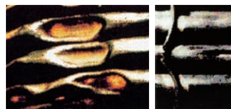
Uszkodzenia węzownic uderzeniami wodnymi
